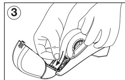
Ziehen Sie das Band ca. 30-40mm aus, sodass der Anfang des Bandes auf dem Gummibandmechanismus abgelegt ist.
