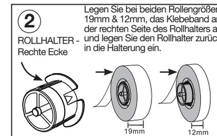
Legen Sie das entsprechende Band auf den Rollhalter auf und setzen Sie es wieder in die Halterung ein.
