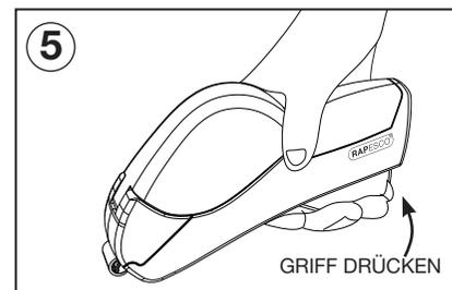
Drücken Sie den Griff, sodass das Klebeband nach vorne durch die Spenderöffnung geführt wird.
